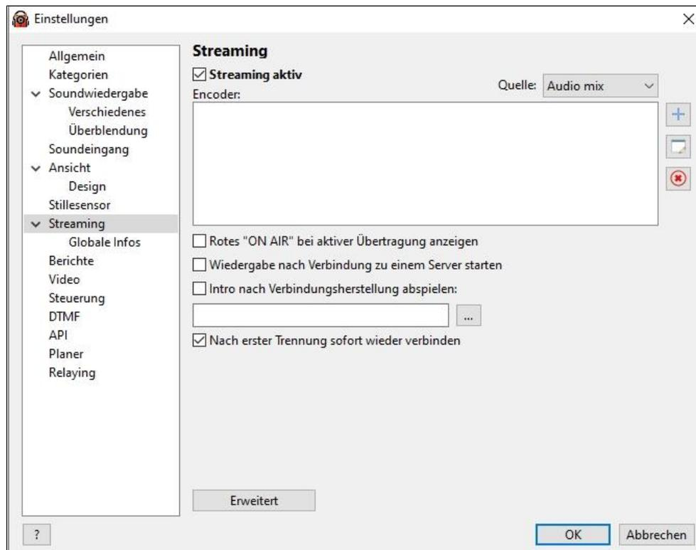
Wählen Sie in der Menü-Baumansicht den Punkt „Streaming“ aus und setzen Sie einen Haken in die Checkbox „Streaming aktiv“.
